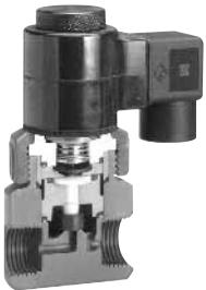
Este diseño compacto, de acción directa proporciona una solución rentable para aplicaciones de alta presión nominal, donde el espacio es limitado. Diseño de seguridad Fail-Dry® patentado. Para casi todo tipo de soluciones: ácidas, cáusticas, solventes, soluciones de cloro y líquidos ultrapuros. Vida útil de 2.000.000. Tamaños de 1/4" y 1/2". Cv de 0,5 con orificio de 3/16"; 0,8 con orificio de 1/4". PVC, CPVC, polipropileno natural, PVDF.
