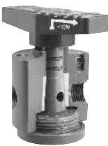
La válvula selectora compacta se ofrece en 2, 3, 4 y 5 vías y perforaciones de múltiples pilas. Ideal para el uso de laboratorio u otras aplicaciones de elección entre numerosas fuentes de líquidos. Ya sean manuales o accionadas, se ofrecen en PVC, CPVC, polipropileno, PVDF o PTFE, en los tamaños de 1/4" o 1/2".
