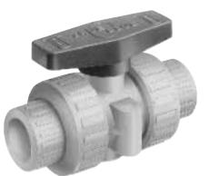
Esta válvula de ingeniería ofrece un hermético sellado de girado fácil con bola lisa perfectamente mecanizada y pulida. Diseñada con doble unión para mantener centrada a la bola, eje reforzado para eliminar roturas y juntas dobles para asegurar la fiabilidad. Los asientos de PTFE están reforzados con juntas tóricas para pares reducidos y una mayor duración de
