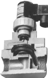
Alta presión, alta capacidad de flujo. Diseño accionado por piloto, requiere de un diferencial de 5 PSI en la válvula. Calibrada para presiones de entrada desde 5 hasta 140 PSI, contrapresiones de 70 PSI. Cv de 5,2 a 80. Diseño de seguridad Fail-Dry® patentado. Junta tipo fuelle PTFE. Para todo tipo de soluciones. Tamaños de 1/2" a 3". PVC, CPVC, polipropileno natural, PVDF.
