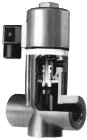
Válvula de acción directa para aplicaciones de servicios importantes con prácticamente todas las soluciones (ácidas, cáusticas, etc.). El diseño particular de "fuelle" proporciona un dinámico sellado de barrera, evita fugas de emisiones. Vida útil de 2.000.000. Diseño de seguridad Fail-Dry® patentado. Tamaños de 1/4" a 1". Cv de 1,1 a 4,7, orificio de 3/8" a 11/16". PVC, CPVC, polipropileno con relleno de vidrio, PVDF.
