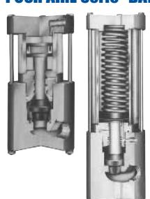
Las válvulas de cierre de 2 vías tipo globo presentan el diseño de eje de PTFE, diseño Fail Dry® y el cilindro de aire de acrílico transparente muestra la posición de la válvula, todo estándar. Válvulas ultrareforzadas con décadas de probada desempeño de resistencia. La serie BAT es de doble acción de aire para abrir, aire para cerrar. La serie BLT
