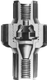
Las válvulas de retención a prueba de fugas evitan el reflujo de agua y líquidos extremadamente corrosivos y ultrapuros. Los diseños de autosellado permiten el montaje en cualquier posición. Diafragma único moldeado en tamaños de 1/2", 3/4" y 1"; cabeza móvil autoguizada en 1 1/2", 2" y 3".
