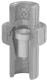
Para ventilación de gas de alta capacidad en el arranque del sistema. La cabeza móvil autoguiada asegura un mínimo de emisión de líquido del sistema y sella más confiablemente que los diseños de tipo bola. Cierra a 0 PSI, siempre y cuando haya líquido; el sello hermético en 10-15 PSI. PVC y CPVC en conexiones de 1/2", 3/4" y 1" NPT.
