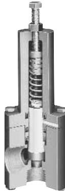
Evite la sobrepresión, mantenga las contrapresiones o la derivación automática en recipientes y tuberías. El patrón dentro de la tubería de la serie RVDM (no se muestra) posee un diseño de diafragma rodante sin roces para operaciones sensibles. La serie RVT es un diseño de patrón de ángulo. Configuración desde 5 a 100 PSI. Fail Dry®, 1/2" a 2". Diseño de diafragma con patrón de ángulo de la serie RVD (no se muestra) de 1/8" a 1/2" NPT, 50 a 150 PSI. Se ofrece serie RVTX en 3" NPT.
