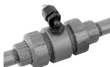
Las válvulas accionadas por aire "pellizcan" el manguito para cerrar el flujo; ideal para lodos o partículas que pueden impedir el cierre hermético en un asiento regular y de diseño.
