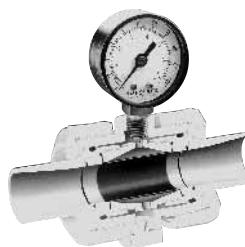
El diseño único en línea elimina el "espacio muerto" que puede albergar el crecimiento de bacterias y la contaminación. Material termoplástico sin pigmento; FKM o EPDM metálico sin iones. El carrete especial flexible del elastómero separa el líquido del sistema del líquido de llenado del calibre y asegura una lectura precisa. Adaptable a los actuales sistemas de tuberías. Tamaños: 1/2" a 2".
