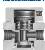
Las válvulas accionadas por aire BSR están normalmente cerradas, ideales para aplicaciones de pureza y corrosivas. Presentan un diseño de sellado hermético de bajo rozamiento, sin metales húmedos. Tamaños de 1/2" y 3/4". Cv de 2,5 y 5,0; 150 PSI máx., servicio de vacío disponible.
