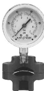
La elección de PTFE o sello de barrera Viton protege los instrumentos de la corrosión y la obstrucción mientras se mantiene una alta precisión. La conexión única del calibre hexagonal de acero (sin humedad) elimina la rotura. Disponible con o sin calibres de presión o vacío de acero inoxidable de 2 1/2". Entrada de 1/2". Conexión del calibre de 1/4" o 1/2". Sellado del diafragma compacto serie GGME (foto) también para presión o vacío.
