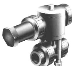
Robusta construcción termoplástica de ingeniería – ideal para ambientes corrosivos. Compacta. Ensamble ligero para esfuerzos de tuberías reducidos. Acople simple a válvulas de bola True Blue™. Salientes de montaje del cuerpo. Control manual estándar en la mayoría de los modelos. Opciones de retorno por resorte. Topes de finales de carrera e interruptor de límite disponibles. Tamaños ABV para 1/2" a 3", bastidor y piñón ABR para los tamaños de 1/4" a 4".
