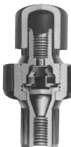
Los igualadores de presión de protección eliminan el sifonaje no deseado o el colapso de los tanques de almacenamiento. El diafragma moldeado sensible ofrece un funcionamiento normalmente cerrado y que responderá a un mínimo de vacío; sin embargo, no se recomiendan para la protección de tanques de pared delgada. Tamaños de 1/2", 3/4" y 1" NPT. La nueva serie VBS presenta un diseño normalmente cerrado y mayor capacidad en tamaños de 1 1/2", 2" y 3" NPT.
